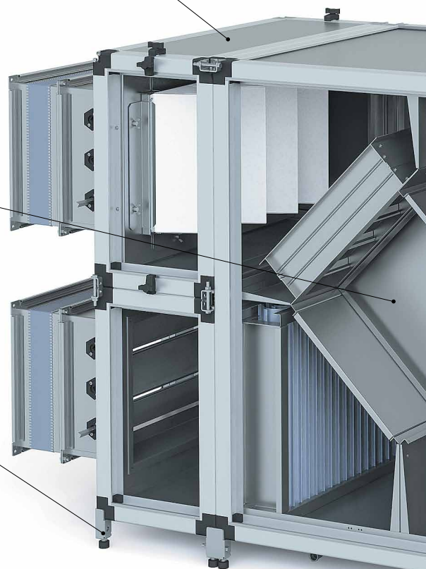
Сэндвич-панели толщиной 25 мм: два стальных оцинкованных листа с легким пенополиуретановым наполнителем. Эффективное снижение шума и тепловых потерь, а также увеличенные прочность и жёсткость корпуса секций.
